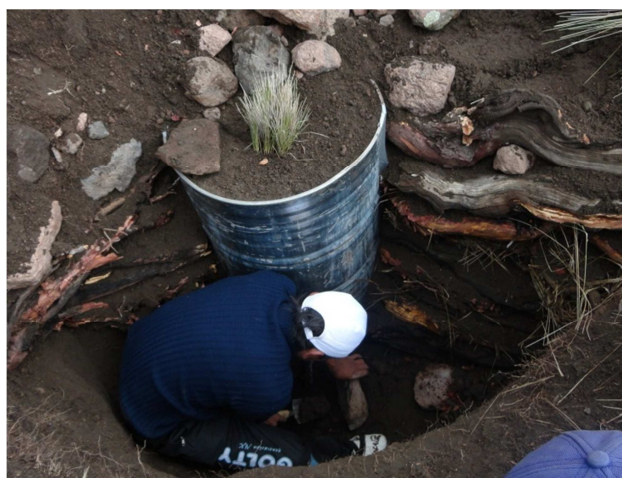
Fig. 6: Registro de agua de escurrimiento profundo del área de almacenamiento de lisímetro con vegetación.
