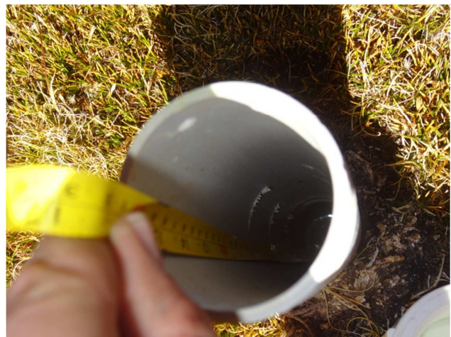
Fig. 4: Medición del nivel freático en piezómetro casero, empleando cinta métrica.
