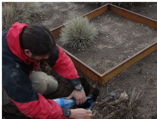
Fig. 9: Parcela para registro de escorrentía (superficial) con 20% de cobertura vegetal. Prototipo instalado en la zona de Aychuta, en el que se observa el punto de recolección de agua capturada.
