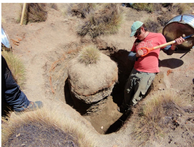
Fig. 5: Formación de pieza monolítica de suelo en proceso de construcción de lisímetro con vegetación.
