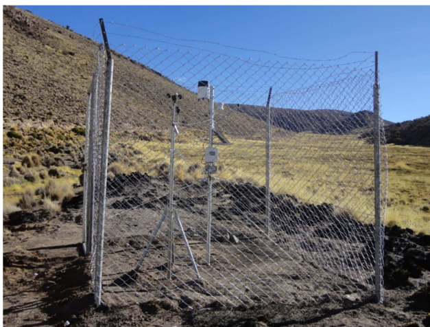
Fig. 7: Estación climática HOBO instalada por Agua Sustentable en la microcuenca del Jaruma
