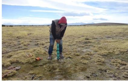
Fotografía 18. Introducción de tubos piezómetros en el espacio perforado.
