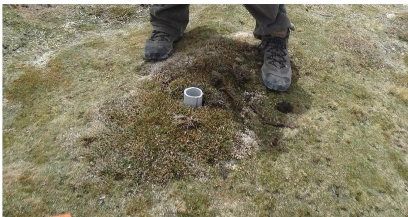
Fotografía 22. Piezómetro SIN TAPA.
