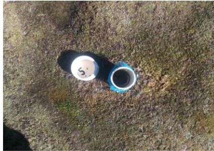
Fotografía 19. Piezómetro instalado con su respectiva tapa y numeración.
