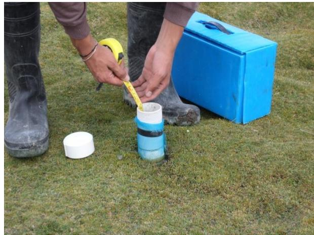
Fotografías 23 - 24. Medición de altura piezométrica en tubos piezómetros.
