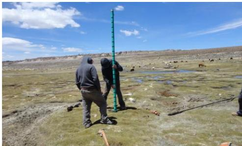
Fotografía 16. Tubo piezómetro revestido con malla.
